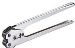
**Клещи Н-34** для зажима металлическим замком ПП ленты. Вес — 1,8 кг. Ширина ленты 12, 16 или 19 мм. Длина ручки 460 мм.
