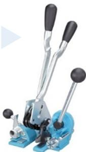
**Натяжитель Н-21** натягивает и обрезает ПП ленту. Используется в комплекте с клещами Н-34 для зажима замком. Или вместе с металлической пряжкой. Вес — 1,4 кг. Ширина ленты 12 – 19 мм.
